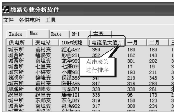
图 1 10 kV 线路负荷最大值的排序
